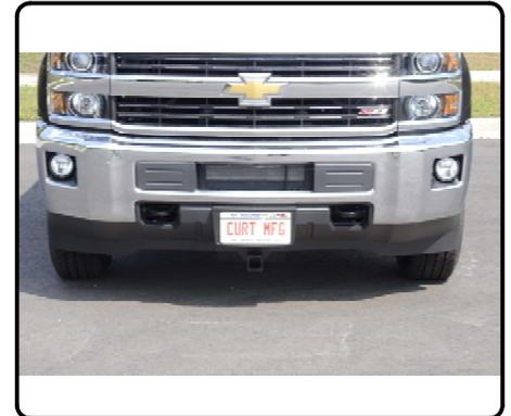
**31071****CHEVROLET / GMC 2500 / 3500****10/28/2014****GROSS LOAD CAPACITY WHEN USED AS A WEIGHT CARRYING HITCH: 5,000 LBS. TRAILER WEIGHT & 500 LBS. TONGUE WEIGHT.****GROSS LOAD CAPACITY WHEN USED AS A STRAIGHT LINE PULL: 9,000 LBS. MAX. LINE PULL.****\*\*\* DO NOT EXCEED VEHICLE MANUFACTURER'S RECOMMENDED TOWING CAPACITY. \*\*\*****HAVING INSTALLATION QUESTIONS? CALL TECHNICAL SUPPORT AT 1-800-798-0813**
